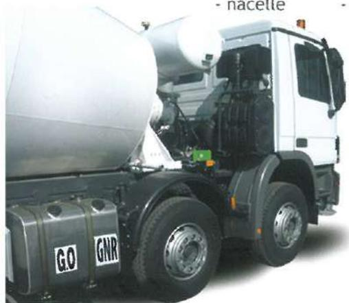
Le basculement gasoil/GNR se fait automatiquement sur simple serrage du frein de parking et à l'enclenchement de la prise de force du véhicule. BIMAX est un procédé de 2<sup>ème</sup> génération qui répond aux exigences des motorisations actuelles
